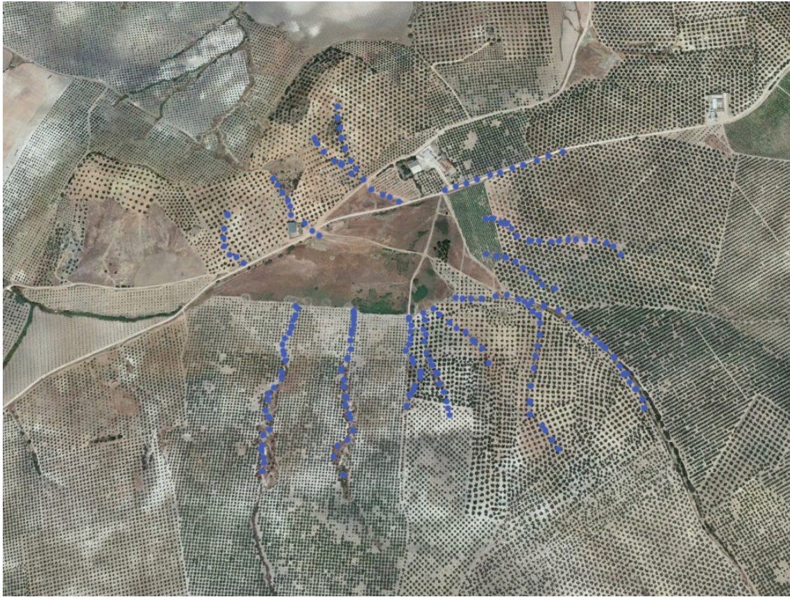
Figura 4. Con trazo azul discontinuo líneas de arroyadas y cárcavas actualmente existentes.
